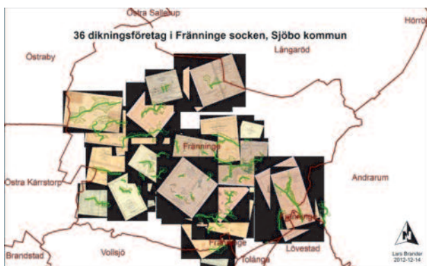
Fig 2. Fränninge socken, med 36 dikningsföretag från före 1920. Rektifierade bilder och digitaliserade dikningsföretag.
